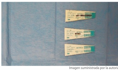
Figura 3.- Integrador químico de vapor control y 2 testigos procesados, uno de manera no satisfactoria (en medio), donde se ve que la banda gris no llega a la zona de seguridad, y el otro donde se cubren las dos zonas (a bajo).
