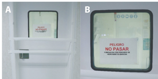
Figura 10.-A. Habitación preparada para ser desinfectada con generador de VHP donde puede apreciarse el testigo químico colorimétrico. B. Detalle del cristal de la puerta con la tira química.
