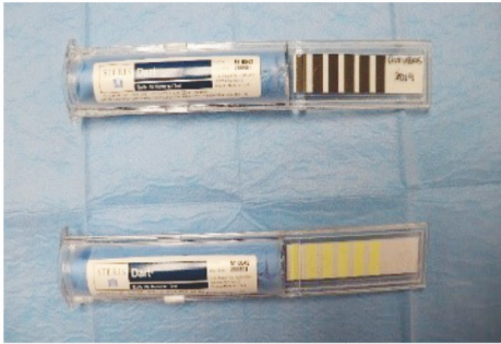
Figura 9.- Test de vacío Dart® con resultado satisfactorio (arriba) y un testigo sin usar (abajo).
