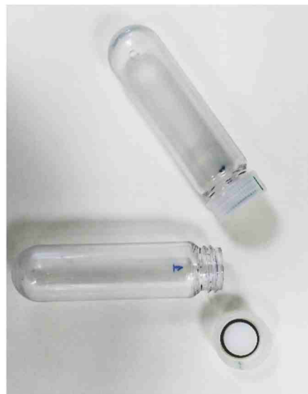
Figura 3.- Tubos de policarbonato equipados con tapa de la marca Beckman Coulter Inc. (California, USA).
