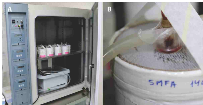
Figura 2.- A. Vista de la alimentación artificial de mosquitos con sangre infectada con P. falciparum y tratados con diferentes compuestos y el baño que mantiene a 37°C el parásito. B. Vista en detalle de la alimentación de los mosquitos con sangre infectada con el parásito. Las muestras biológicas humanas han sido obtenidas de proveedores autorizados que cumplen con la formativa GSK y la extracción ha sido aprobada por los comités éticos pertinentes.
