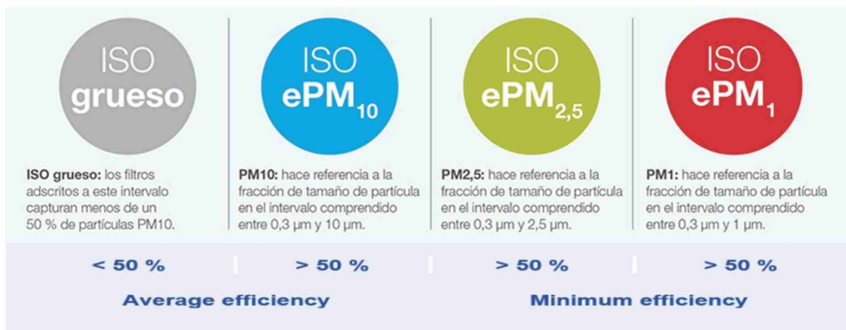
Figura 4.- Clasificación ISO 16890, en la que se muestran las capacidades mínimas de filtración que ha de cumplir cada tipo de filtro para encuadrarlas en cada clase.
