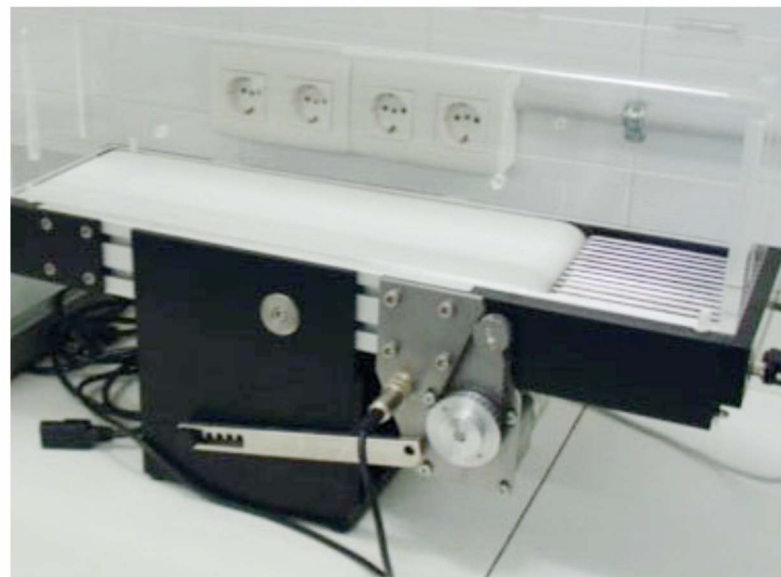
Figura 1.- Cinta corredora o treadmill utilizado en ratones para medir la resistencia al ejercicio.
