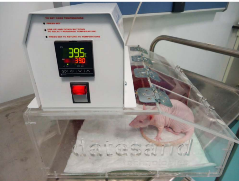
Figura 2.- Cámara Thermacage® programada a una temperatura de 39 °C (display rojo). Los dígitos verdes indican la temperatura real en el interior de la cámara.
