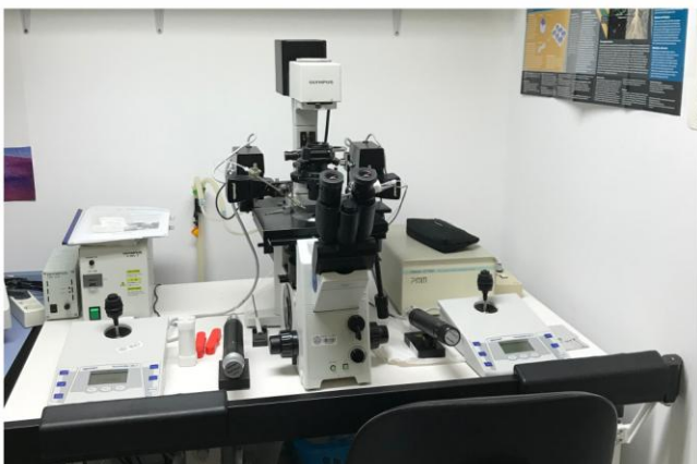
Figura 5.- Área en la que se realiza el proceso de microinyección de embriones e ICSI. Cuenta con una estación de microinyección compuesta por mesa antivibratoria de gas, micromanipuladores, microscopio invertido y piezo-drill.
