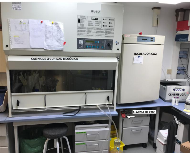
Figura 3.- Área donde se realiza el cultivo de células y embriones. Cuenta con una cabina de flujo laminar de seguridad biológica IIA y un incubador de CO 2 .
