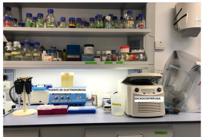
Figura 4.- Área de biología molecular. Cuenta con micropipetas, microcentrifuga y fuente de electroforesis, entre otros instrumentos.
