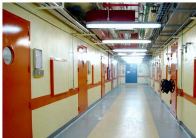
Figura 4.- Pasillos de distribución amplios y de fácil limpieza. Si es de paso de animales, el suelo deberá ser antideslizante para evitar accidentes. Instalaciones del INIA-CISA.
