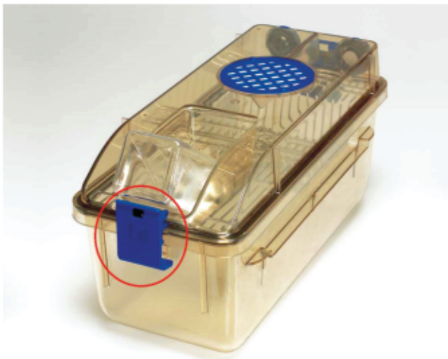
Figura 7. - Los clamps deben de permanecer sueltos durante el autoclavado.
