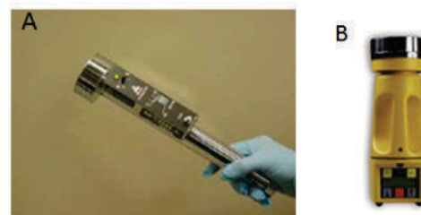
Figura 9.- A) Recolector RCS (Reuter centrifugal system). B) Muestreador SAS (Surface air system).
