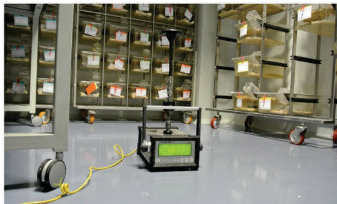
Figura 3.- Medidor de partículas trabajando en una sala de alojamiento de ratones. Obsérvese la mala posición del rack central, que dificulta la salida del aire por la rejilla de extracción.
