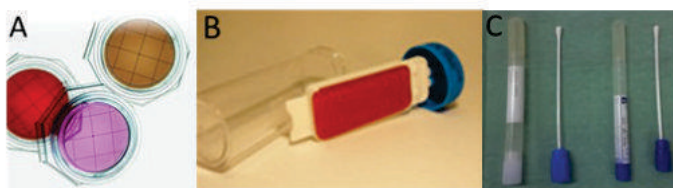
Figura 8.- A) Placa Rodac. B) Placa de laminocultivo de 10 cm 2 . C) Hisopos estériles con medio de transporte.
