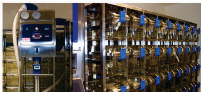
Figura 9.- Detalle de la impulsión y extracción en un rack ventilado. Las jaulas se descontaminan simultáneamente.
