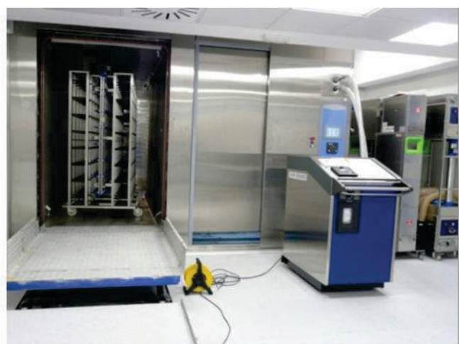
Figura 11.- Descontaminación de la cámara de un lava racks mediante VHP
