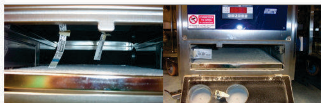
Figura 10.- Detalle de la colocación de indicadores químicos y biológicos en los plenum de impulsión y extracción.
