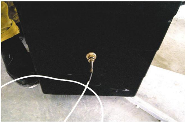
Figura 4.- Sonda de temperatura insertada en el interior de la caja.
