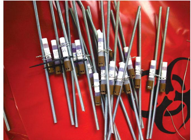
Figura 2.- Preparación de los indicadores biológicos para la validación de un ciclo.
