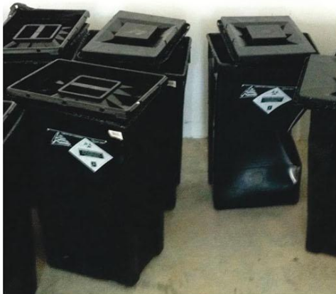
Figura 5.- Cajas deformadas tras el ciclo de autoclave.
