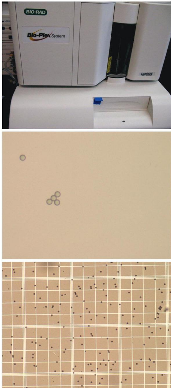
Figura 3.- Equipo que permite leer MFI. Esferas fluorescentes miradas bajo el microscopio en un hematocítómetro para poder calcular el número antes de cubrir las con antígeno.
