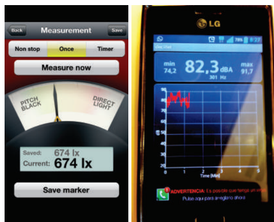
Imagen 2.- Imagen de un iPhone midiendo intensidad lumínica y un móvil Android midiendo nivel sonoro.
