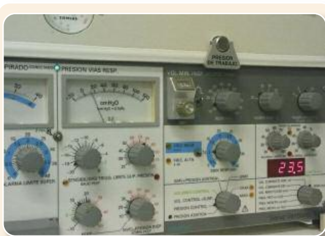
Figura 1. Panel frontal del ventilador automático Servo 900 C, SIEMENS®. En él se observa la configuración de los parámetros establecidos por el anestesista durante la inducción anestésica y la aparición de las irregularidades.
