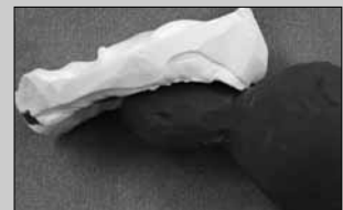
Figura 3. Molde de silicona de la tetina. Su extremo se modela para adaptarlo perfectamente al molde en escayola del paladar.
